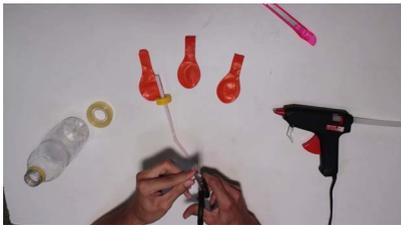
3. Corte a ponta do segundo canudo na diagonal para melhor encaixe no furo anterior.
