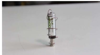
2. Enrole o fio ao redor do conjunto ímã-pilha de forma que o fio encoste apenas no ímã e no polo positivo da pilha e observe o fenômeno ocorrer.
